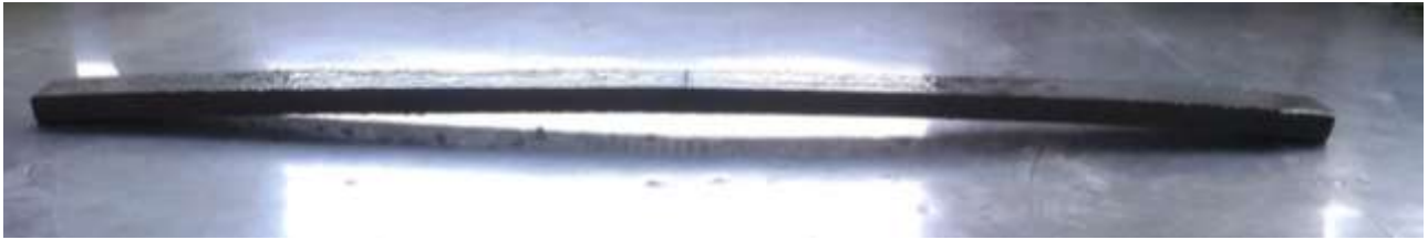
Esempio di risultato di inarcamento di miscela test
